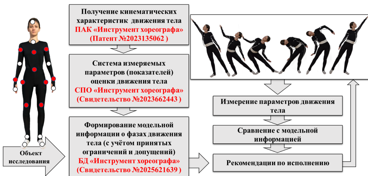
Рис. 2: Структурная схема алгоритма оценки кинематических характеристик базовых движений тела
