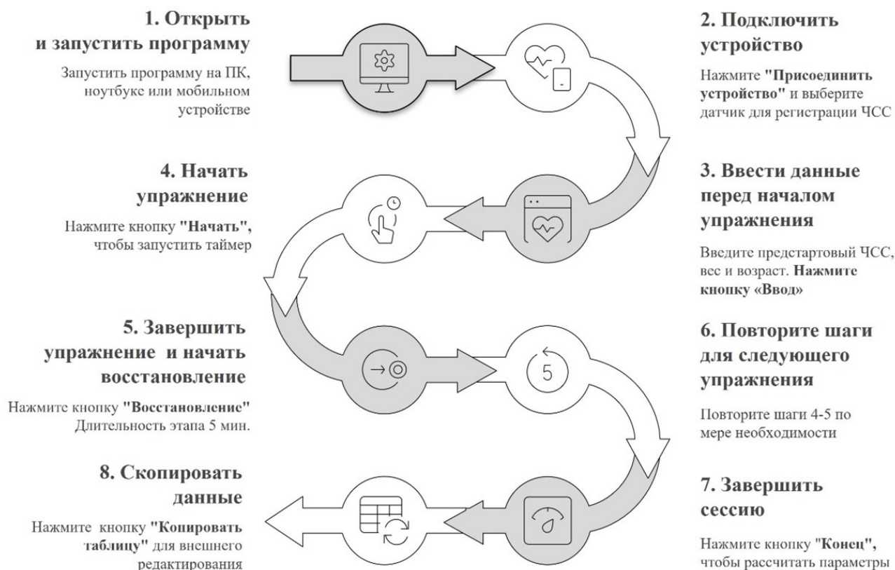
Рис. 3: Алгоритм взаимодействия пользователя с программой Fig. 3: The algorithm of user interaction with the program
