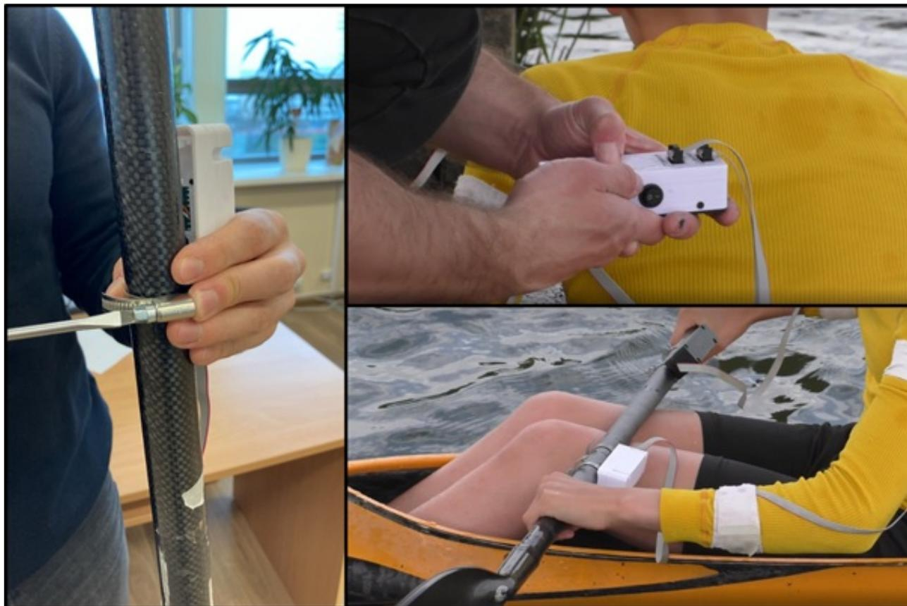
Рис. 1: Портативный тензометрический датчик на древке весла.
