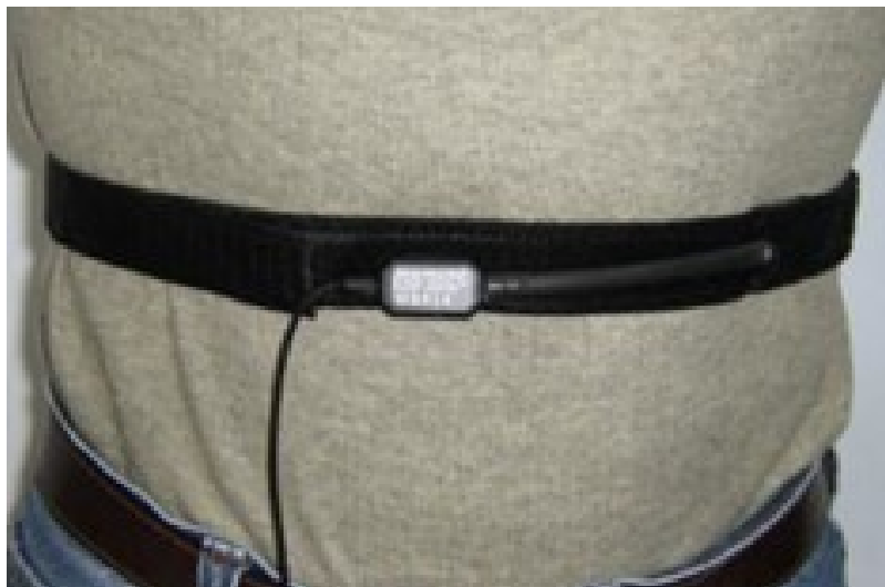
Рис. 2: Крепление пневмографического датчика в области диафрагмы.
