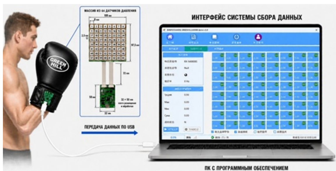
Рис. 2: Общая конструкция сенсорной боксёрской перчатки: расположение матрицы 8 \times 8 на ударной поверхности, модуля сбора данных в области манжеты и системы передачи данных на персональный компьютер
